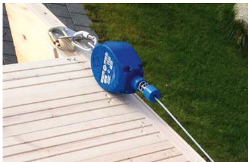
Exemple point A: dispositif d'assurage au faîte
