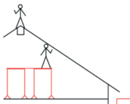
Avec échafaudage de retenue
