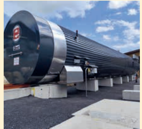
↑ Aspect vieux bois par la vapeur et la pression : le bois est introduit dans l'installation et obtient sa patine grâce à la température élevée de la vapeur sous haute pression.
