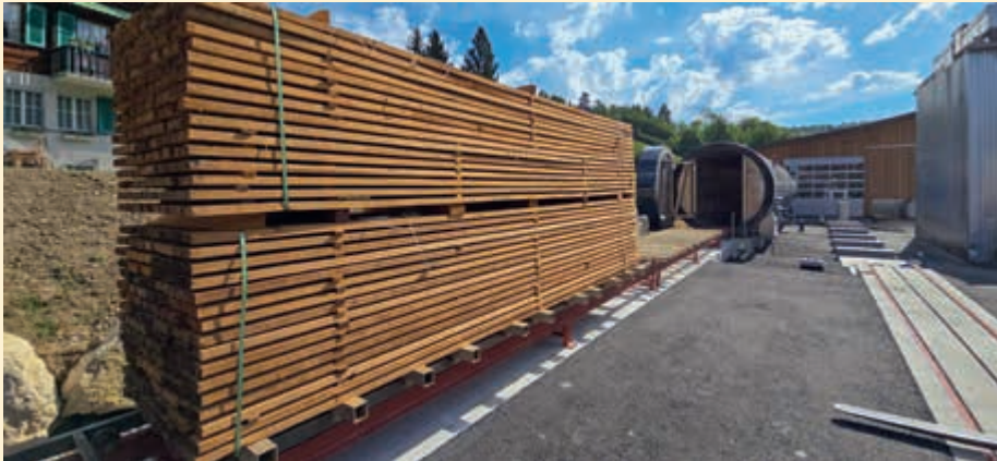
↑ Aspect vieux bois par la vapeur et la pression : le bois est introduit dans l'installation et obtient sa patine grâce à la température élevée de la vapeur sous haute pression.
