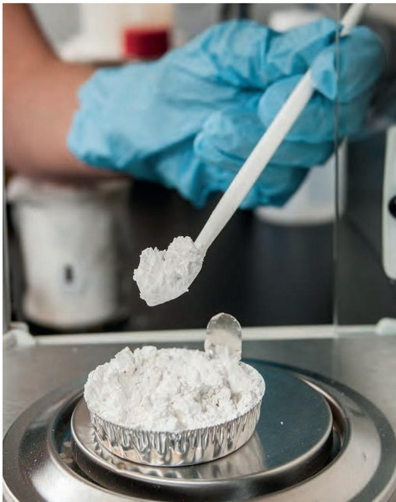
← Dans chaque fibre de cellulose se trouvent des nanocristaux de cellulose de renforcement, ou CNC, qui sont des chaînes de polymères organiques disposées en motifs cristallins presque parfaits, et sont, à l'échelle nanométrique, plus solides et plus rigides que le Kevlar. Ici, cellulose nanocristalline de CelluForce.
