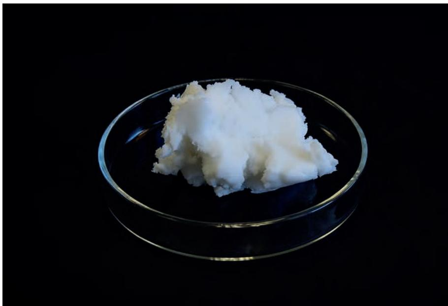
← Les nanocelluloses investissent de façon importante le marché des nanocomposites grâce à leurs propriétés mécaniques et optiques particulièrement intéressantes. Ici les microfibrilles de cellulose du projet européen Exilva.
