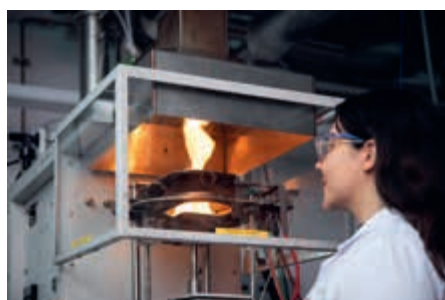
↑ Les chercheurs ont soumis leur plastique ignifuge à des tests d'inflammabilité.
