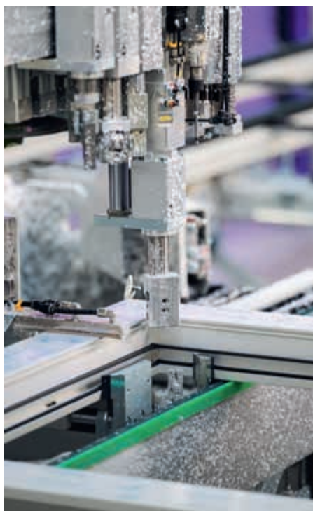
↑ Nouvelle soudeuse-ébavureuse Urban CUT. ↓ Détail du travail d'ébavurage sur un angle de cadre.
