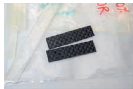
↑ La résine transparente peut être utilisée seule ou en tant que matériau composite avec des fibres de carbone.
