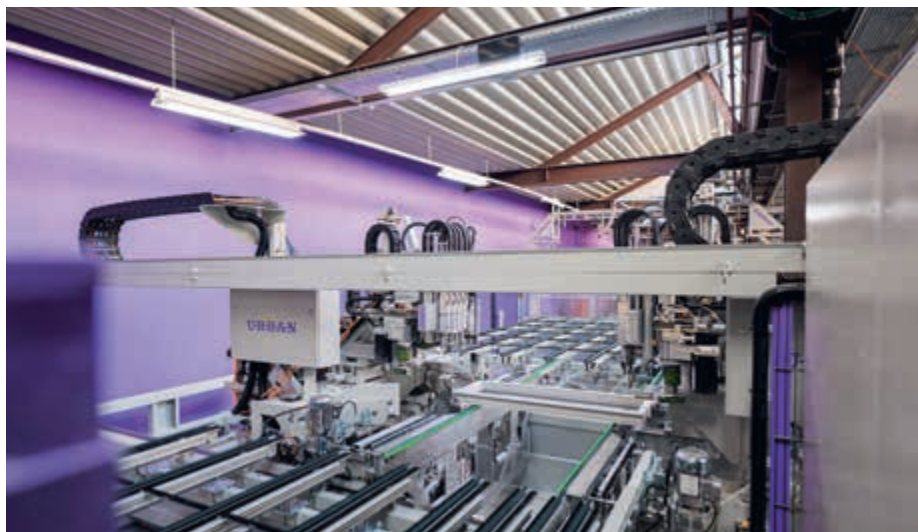
↑ Nouvelle soudeuse-ébavureuse Urban CUT. ↓ Détail du travail d'ébavurage sur un angle de cadre.
