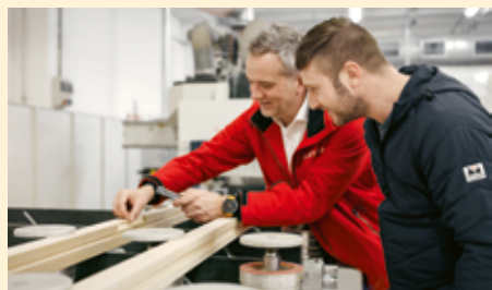
↑ Machiniste CNC de Telser Türen avec le représentant Veico Strim lors de l'inspection de la qualité d'usinage du fraisage de la gâche.
