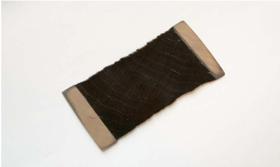
↑ Le bois super-noir empêche intrinsèquement la lumière de s'échapper plutôt que de dépendre de pigments noirs.
