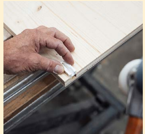
↑ Positionnement de l'élément d'assemblage Cabineo X après usinage
