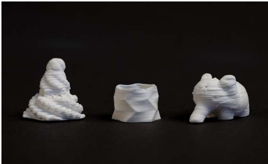
↑ Complexité et légèreté : les chercheurs de l'Empa ont développé un procédé d'impression 3D pour l'aérogel de cellulose biodégradable.
