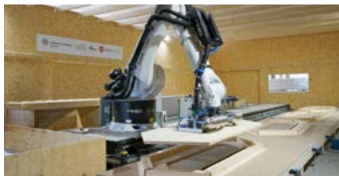
↑ La fabrication robotisée des cassettes creuses
