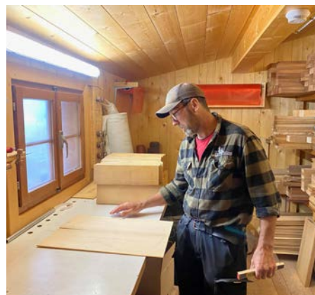
↑ Andrea Florinett contrôle un gabarit d'instrument. Les contours du corps de l'instrument sont reportés directement sur le bois de résonance.
