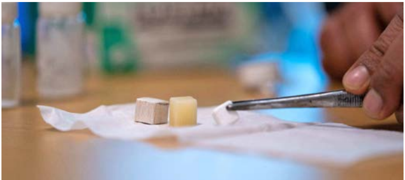
↑ Bois naturel (à gauche) versus bois délignifié. L'élimination de la lignine du bois le rend incolore.
