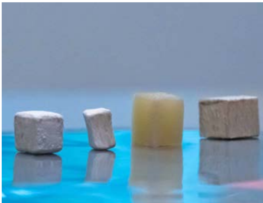
↑ Pièces de bois à différents stades de modification, du bois naturel (à l'extrême droite) au bois délignifié (deuxième à partir de la droite) en passant par le bois fonctionnel séché, blanchi et délignifié (deuxième à partir de la gauche) et le bois fonctionnel infusé par MOF (premier à gauche).
