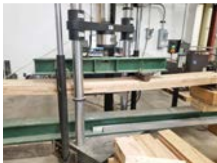
↑ Un segment de panneau est soumis à des tests de rupture et de flexion au WVU
