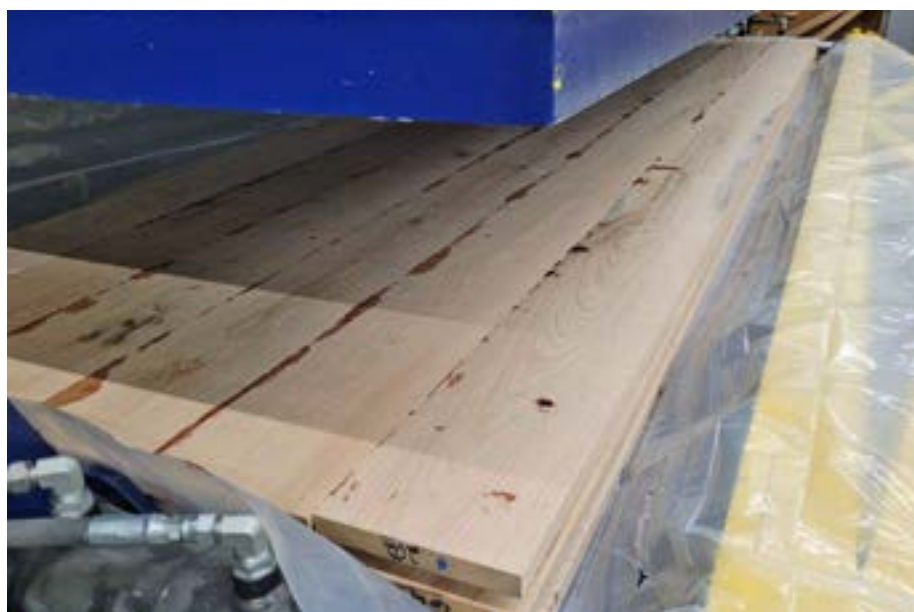
↑ Un panneau de bois produit à l'université de Virginie-Occidentale, dans le cadre des recherches de Joseph McNeel et de son équipe du WVU axées sur les moyens d'utiliser le peuplier jaune comme source de matériaux de construction en bois d'ingénierie
