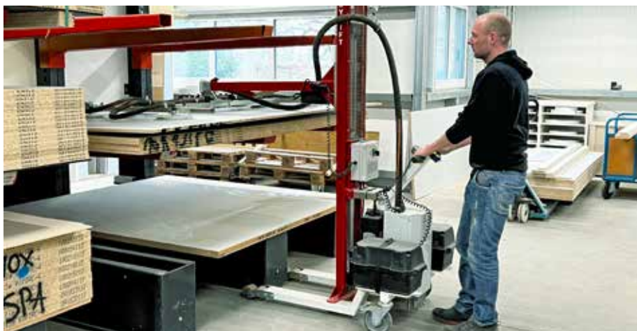
↑ Les moyens auxiliaires, à l'instar des lève-panneaux, facilitent le transport de panneaux à base de bois et réduisent les sollicitations exercées sur le corps.
