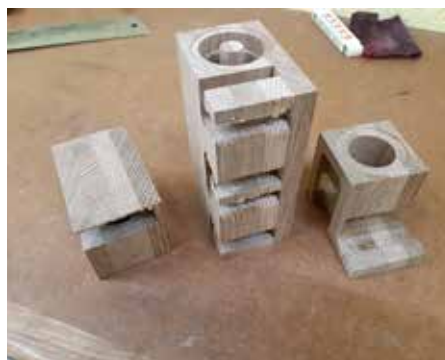
↑ Éléments de la fourche avant, réalisés à la CNC
