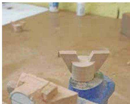
↑ Façonnage des ailettes de fixation des roues
