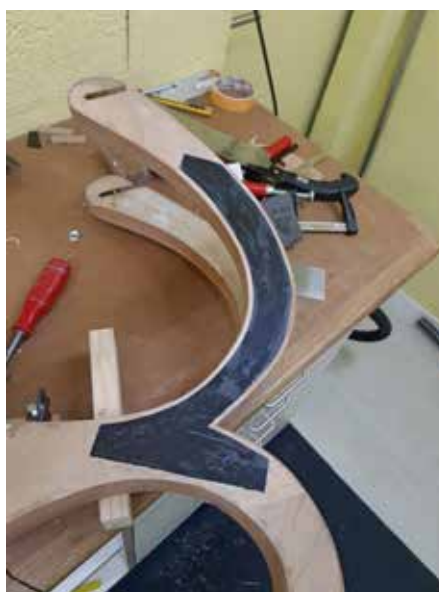
↑ Renfort en carbone de la fourche arrière
