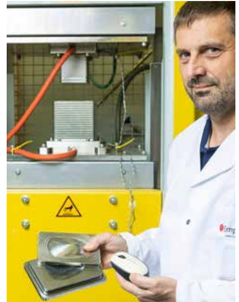
↑ Sous une pression de 150 tonnes, les fibres de cellulose sont d'abord déshydratées, puis consolidées lors d'une deuxième étape. Thomas Geiger devant sa presse spéciale avec les outils.
