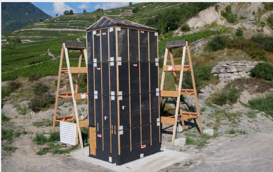
↑ Essais dynamiques sur un bâtiment en bois de quatre étages réalisés à Chamoson (Valais) en 2019 par la Haute Ecole Spécialisée Bernoise BFH-AHB. De nouvelles recherches sont prévues sur la base cette fois de parois en bois lamellé croisé.
