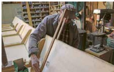
↓ Rabotage des flancs de la barque restés bruts
