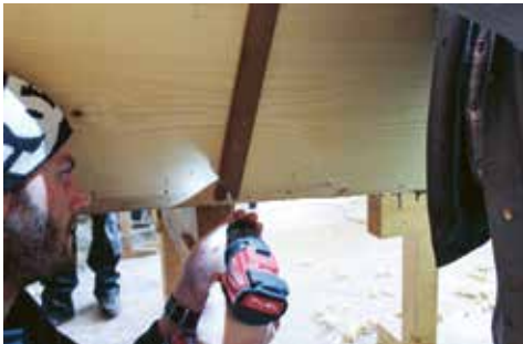
↓ Assemblage de la proue
