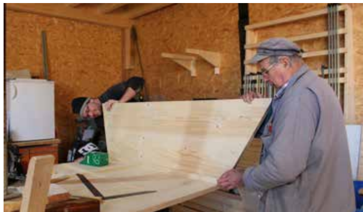
↓ Assemblage de la proue
