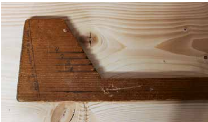
↑ Chablon historique utilisé pour la prise de mesures
