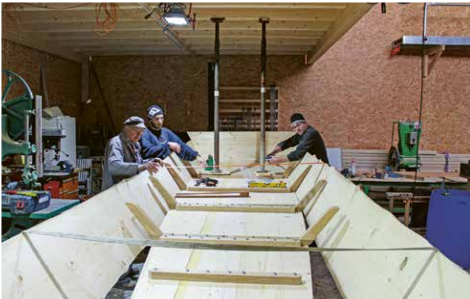
↓ Assemblage de la proue
