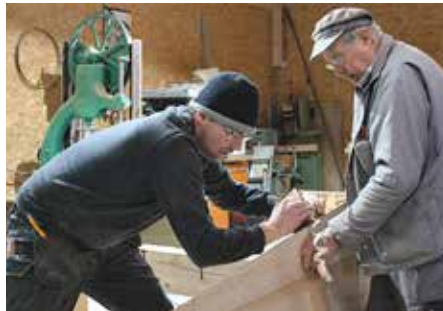
↓ Rabotage des flancs de la barque restés bruts
