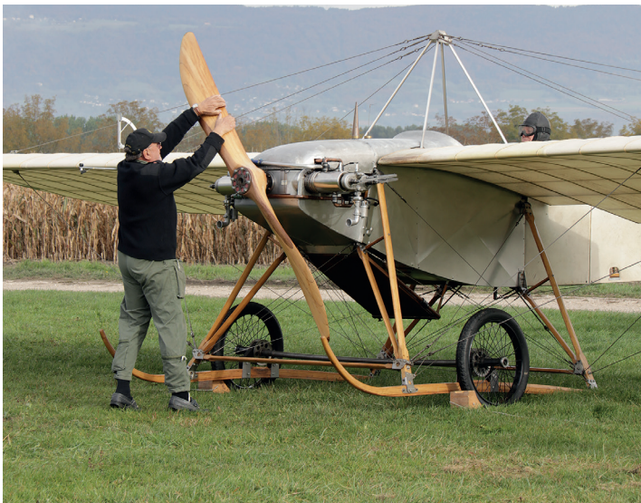
↓ Démarrage du moteur à l'hélice
