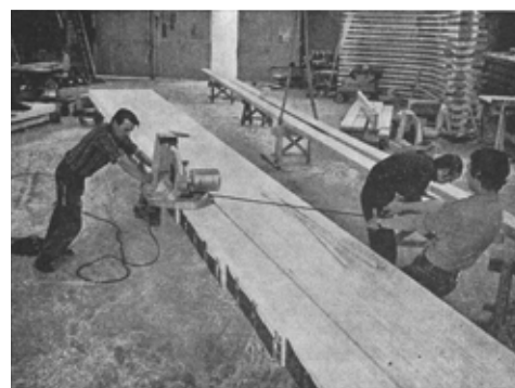
Découpe de la pièce. La pièce, préalablement rabotée, est coupée à ses dimensions définitives.
