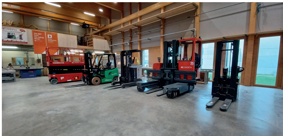
↑ Machines de levage appartenant à l'EJB (de g. à dr.): Nacelle à ciseaux (3a), chariot élévateur à contrepoids (R1), chariot élévateur à mât rétractable et à siège transversal (R2), chariot élévateur quadridirectionnel (R2-R3), gerbeur électrique à timon (S2)
