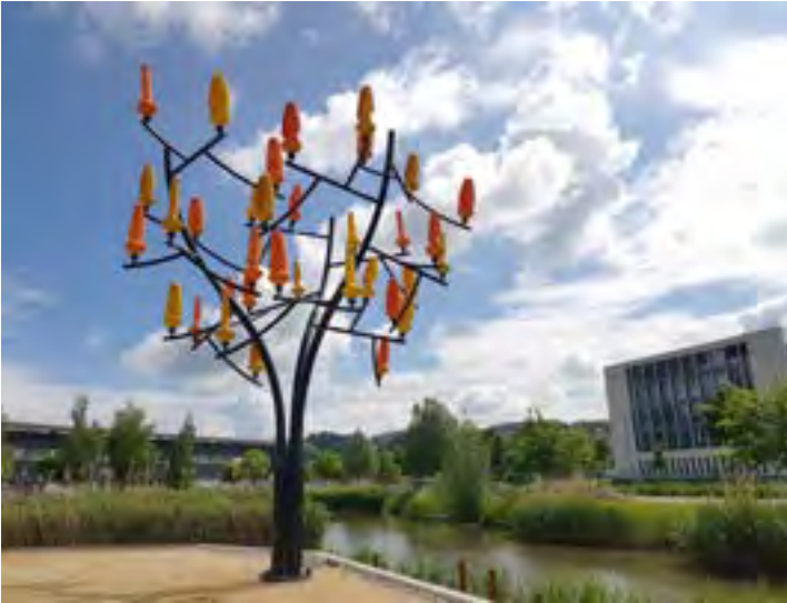
↑ Arbre à vent : chaque feuille travaille comme une mini-éolienne pour exploiter tous les types de vent sur 360°
