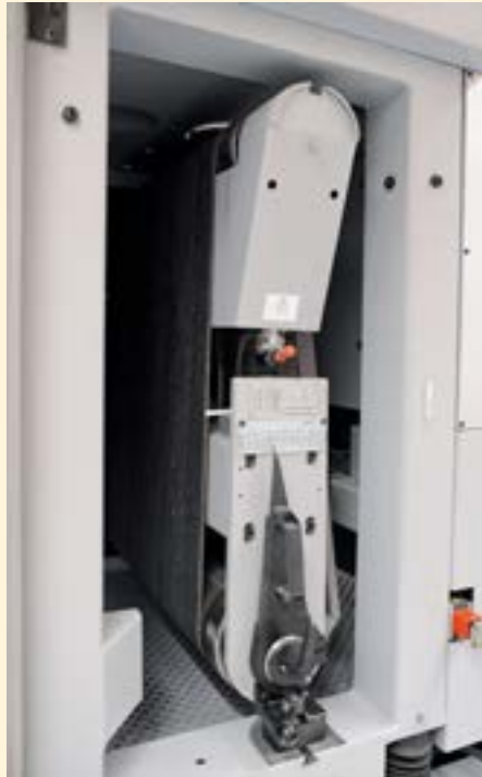
↑ L'unité de ponçage se déplace selon l'axe.
