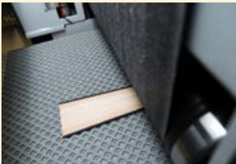
↑ Le serrage par le vide guide les pièces en toute sécurité à des vitesses de coupe allant jusqu'à 16 mm.
