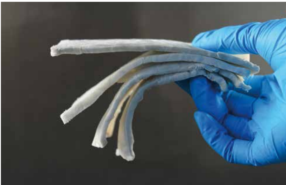
↑ Echantillon du matériau de blindage du laboratoire Cellulose & Wood Materials de l'Empa
