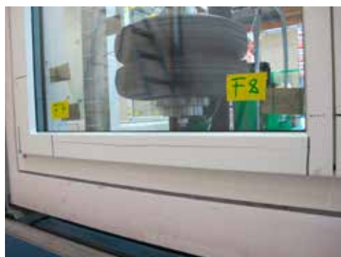
Figure 12: Corps d'impact pour essai dynamique
