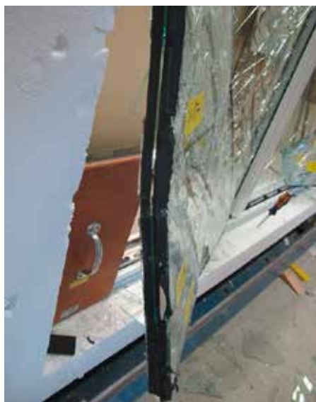
Figure 14: Test manuel de la liaison du verre. Une ouverture de passage a été obtenue
