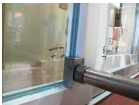
Figure 11: Tampon de test pour l'essai statique d'un remplissage transparent
