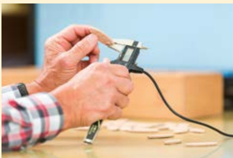
↑ Tests de qualité sur les lamelles
