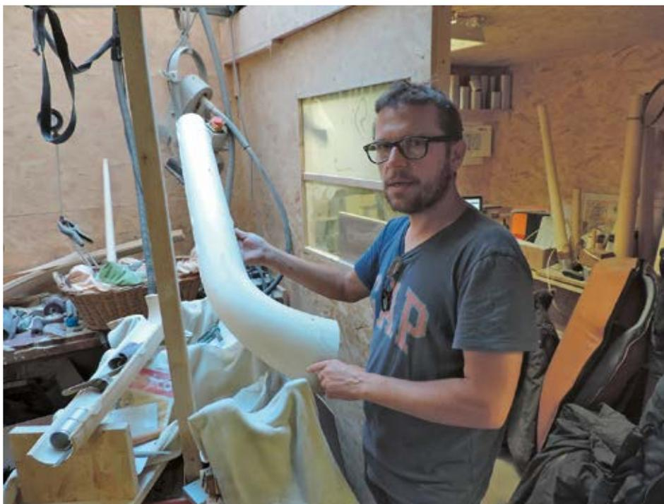
↑ Ebauche précise de demi-coque réalisée à la défonceuse.
