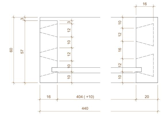
Schublade fertig verleimt - verputzt / Tiroir fini collé - poncé Fertigmass / mesure fini: 340x440x60mm
