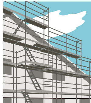
3 Accès à un toit en pente par un échafaudage avec une cage d'escalier.
