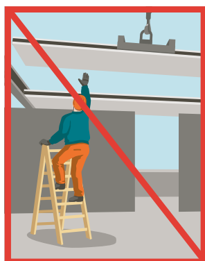
1 Ne pas stationner sous une charge suspendue.
