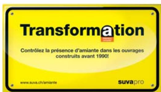
**1** Dans les ouvrages construits avant 1990, la présence d'amiante doit être vérifiée avant le début des travaux.
